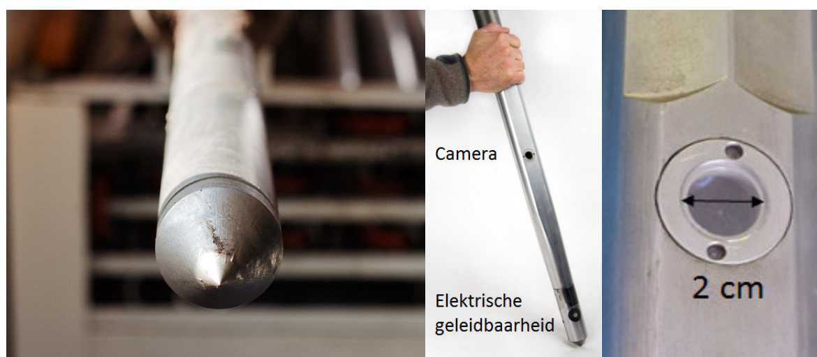
Elektrische CPT conus; camera- en elektrische geleidbaarheidsconus; grootte van het zijvenster voor de camera
