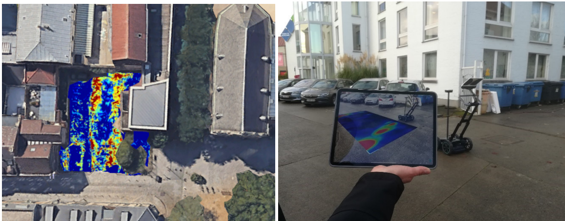
Horizontale dwarsdoorsnede op 1m-mv (Links); Visualisatie leidingen om graafschade te voorkomen (Rechts)
